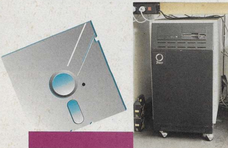
[1] Unix-Computer mit Spezialauftrag: Trace-Mountain mit 68030-Mikroprozessor
