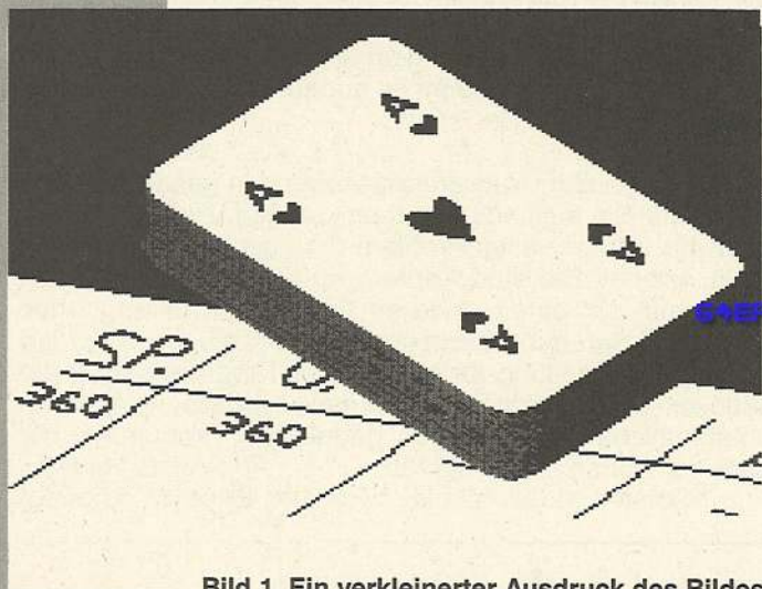
Bild 1. Ein verkleinerter Ausdruck des Bildes »SKAT«. Der Ausdruck erfolgte auf einem Epson FX-85 mit den Parametern »S,1920,850«.
