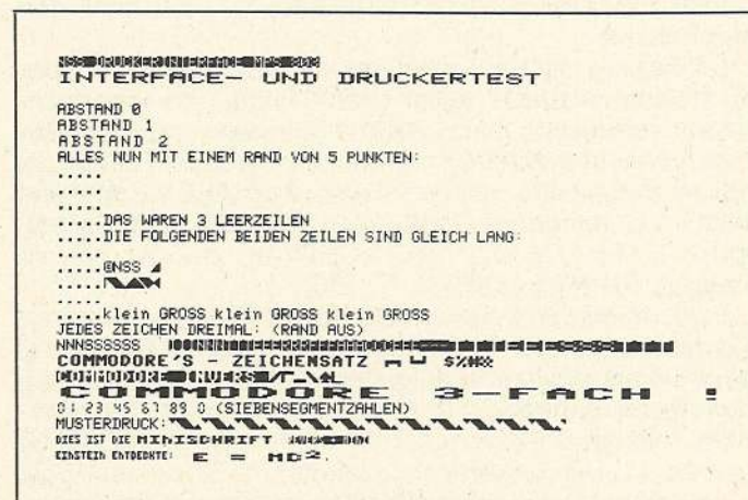
Bild 1. Probeausdruck des eingebauten Selbsttests
