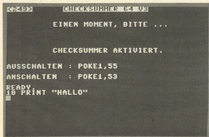
»Checksummer«, die Basic-Eingabehilfe. Links oben sehen Sie die Prüfsumme für die Programmzeile unten.
