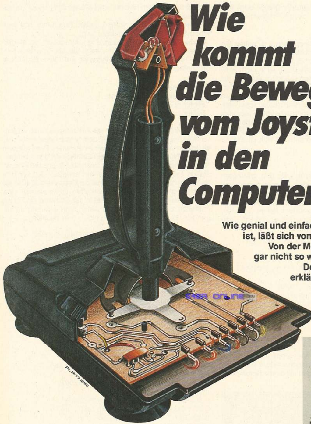
Bild 5. Nach diesem Prinzip sind die meisten Joysticks verdrahtet.
