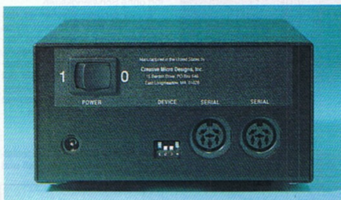
An der Rückseite befinden sich DIP-Schalter, mit denen man die Geräteadresse zwischen 8 und 15 einstellen kann sowie die Anschlußbuchsen
