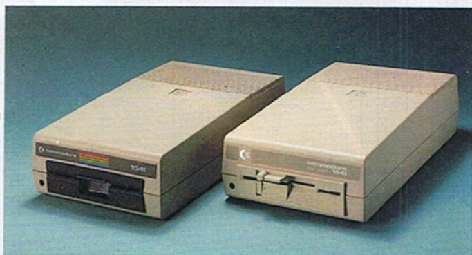
Floppy 1541: 160 KByte auf einer Diskettenseite
