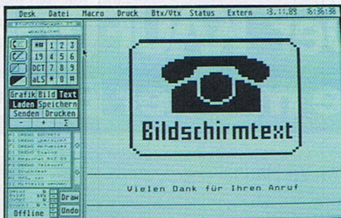
9 Das Atari-Btx-Manager-Menü ermöglicht fast alle Steuerungseingaben mit der Maus, zu sehen neben dem Btx-Bildschirm
