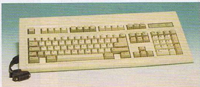
Ein Adapter, ein neuer Prozessor und ein Treiber-Programm machen die AT-Tastatur kompatibel zum C 64
