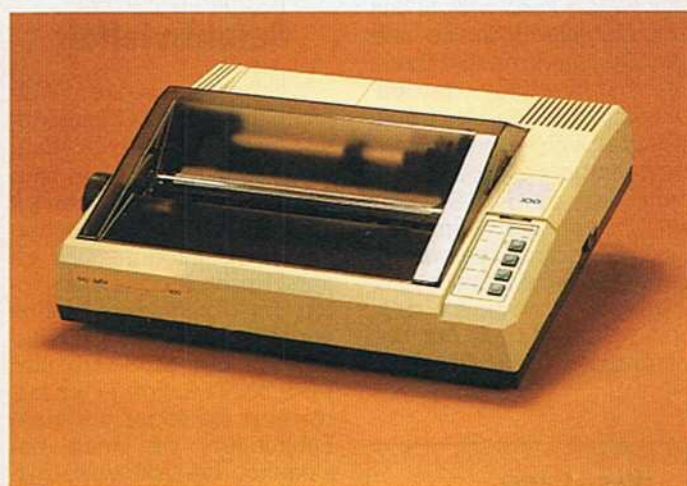
Bild 1. Der Comdata M-100 — ein Neun-Nadel-Drucker zum günstigen Preis
