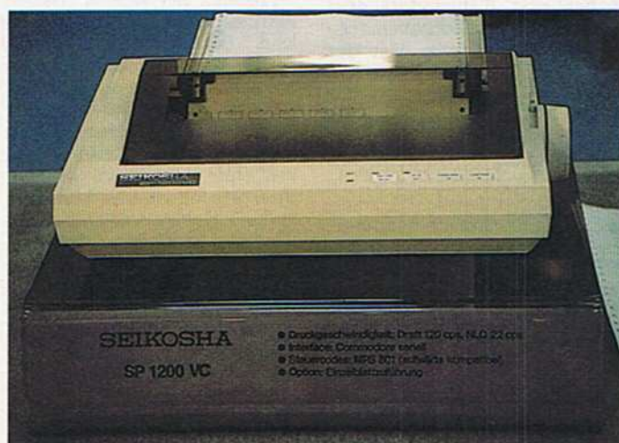
Bild 8. Seikosha SP 1200 VC: Der 9-Nadeldrucker ist direkt am Commodore-Computer anschließbar
