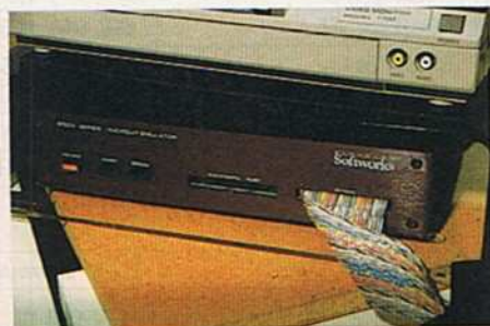
Bild 3. Der ICE (In Circuit Emulator) ist ein unersetzliches Werkzeug beim Programmieren
