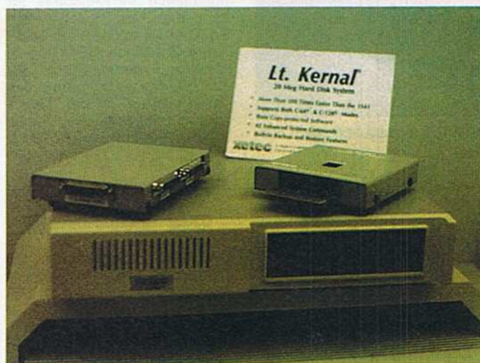
Bild 3. Bald ist sie auch in Deutschland erhältlich: Die 20-MB-Festplatte für den C 64 mit Freezer und Steckverteiler
