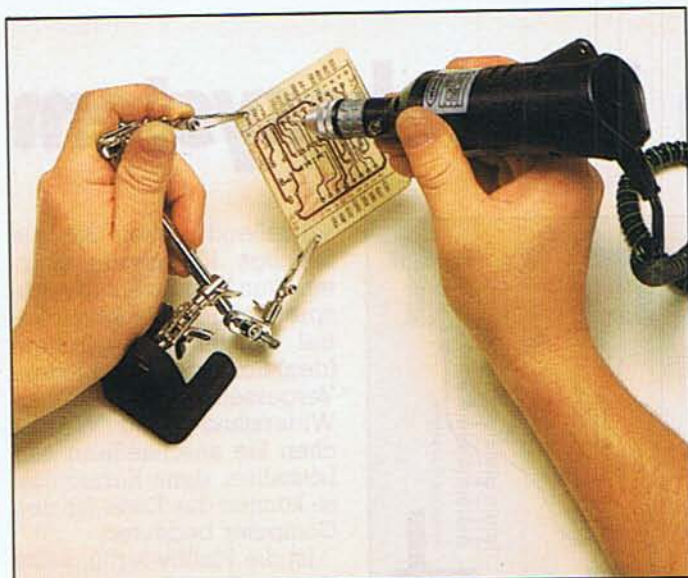
Bild 8. Die Platine bohrt man am besten mit einer Minibohrmaschine
