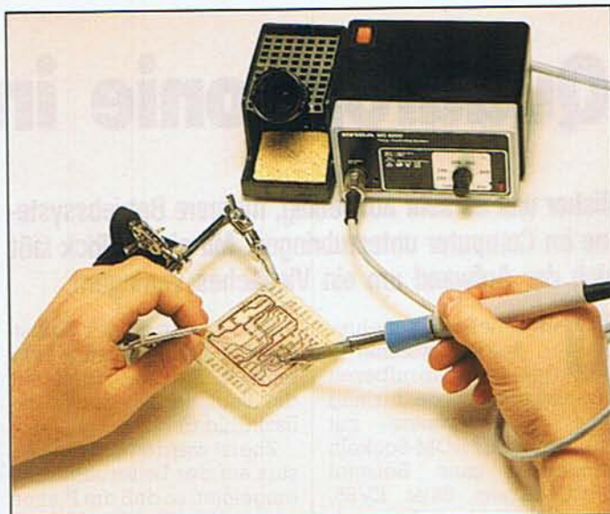
Bild 9. Die Bauteile dürfen beim Lötén nicht überhitzt werden
