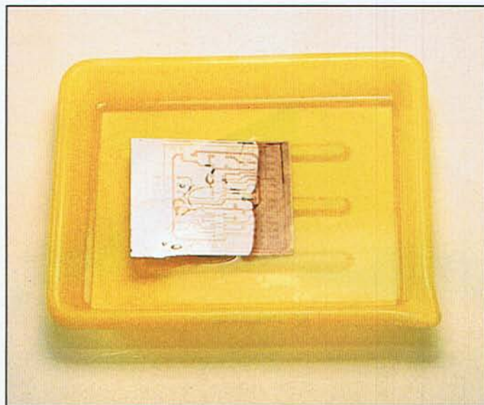
Bild 6. So sollte die belichtete und entwickelte Platine aussehen
