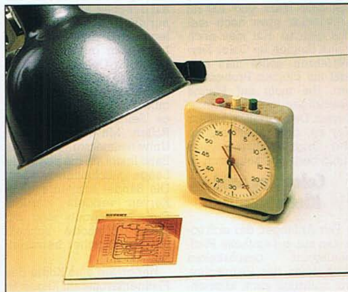
Bild 5. Die Belichtung der Platine sollte eher zu kurz als zu lang sein. Die Fassung sollte die Leistung der Birne verkraften.
