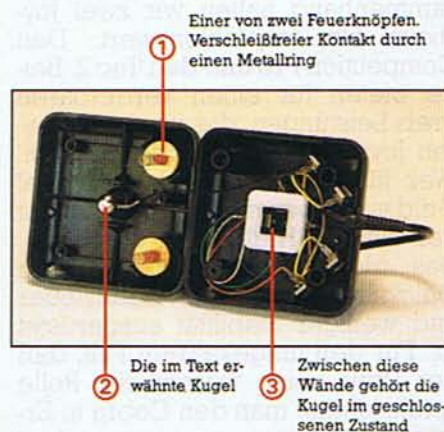
Bild 2. Die Mechanik des TAC 2.
