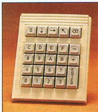
Die Selbstbau-Hextastatur aus der letzten 64'er-Ausgabe gibt es als Bausatz und Fertiggerät.
