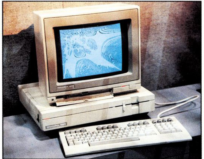
Bild 2. Der PC 128 hat in der »D«-Version das Diskettenlaufwerk bereits integriert
